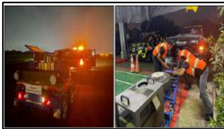
Kegiatan Pengujian Daya Dukung Perkerasan (HWD) di Bandara Soekarno – Hatta – Jakarta
