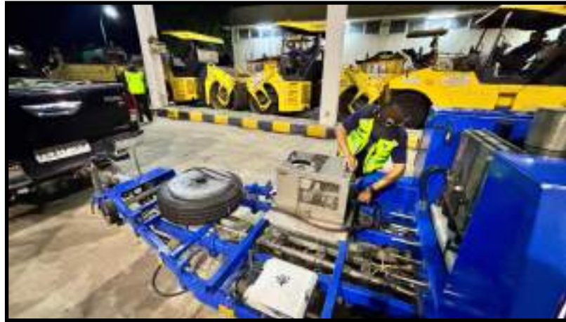
Kegiatan Pengujian Daya Dukung Perkerasan (HWD) di Bandara Udara Hang Nadim - Batam
